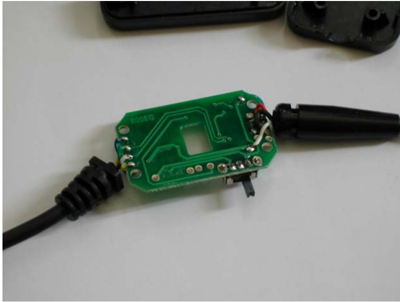
Bild 6 Platine mit angelötetem Verbindungskabel
